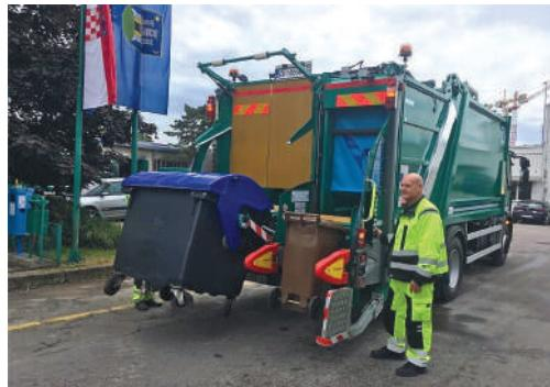
**U 2019. nabavljeno je i vozilo za istovremeni odvoz dvije vrste otpada. Riječ je o posebnom vozilu za skupljanje i prešanje svih vrsta otpada (miješani komunalni otpad, papir, biootpad, plastika), s dvije neovisne (odvojene) komore za prešanje, koje omogućuju istodobno pražnjenje do 3 spremnika. Ovo je prvo takvo vozilo u voznom parku podružnice Čistoća.**
