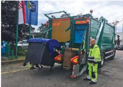
U 2018. nabavljeno je i vozilo za istovremeni odvoz dvije vrste otpada. Riječ je o posebnom vozilu za skupljanje i prešanje svih vrsta otpada (miješani komunalni otpad, papir, biootpad, plastika), s dvije neovisne (odvojene) komore za prešanje, koje omogućuju istodobno pražnjenje do 3 spremnika. Ovo je prvo takvo vozilo u voznom parku podružnice Čistoća.
