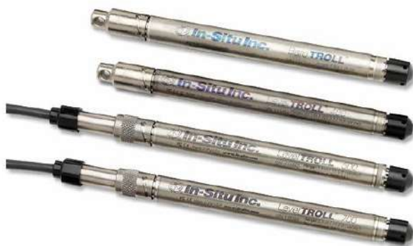
Slika 2.2. Senzor Level Troll 700 tvrtke In-Situ Inc., također je korišten prilikom mjerenja.
