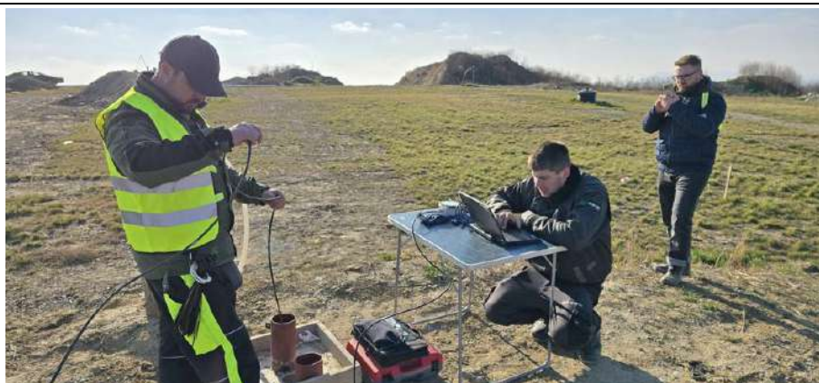
Slika 4.9. Mjerenje na piezometru CPT-1
